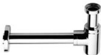
Art. 10009 Sifone tondo in ottone ribassato 1" 1/4 cromato Cp Brass round trap, shorted 1" 1/4 chromed Syphon petit culot laiton chromé Siphon aus verchromtem messing, abgeflacht Sifón redondo de latón rebajado 1" 1/4 cromado Сифон круглого сечения 1" 1/4 укороченный, из хромированной латуни
